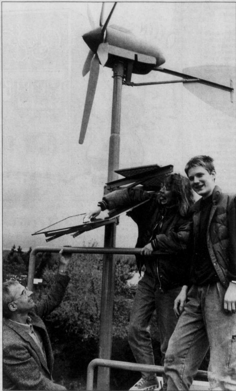
Cet engin intègre deux formes de production d'électricité, l'éolien et le photovoltaïque.
