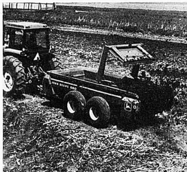
Ce nouvel épandeur 660, de 300 boisseaux, est l'un des deux nouveaux modèles récemment présentés par John Deere. L'autre est le 680, de 400 boisseaux. Leur grande capacité accélère les travaux d'épandage de fumier. Le 680, dont la charge utile est de 11 tonnes, est l'épandeur remorqué le plus gros actuellement mis sur le marché par les principaux fabricants. Le modèle 660 de 8 1/2 tonnes ne le cède qu'au modèle 680. Les deux sont pourvus du premier système de commande hydraulique livré en série.
