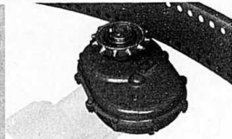
Couronne motrice indépendante à boîte d'engrenages flottante, protégée par embrayage à glissement, d'entraînement net à crémaillère.
